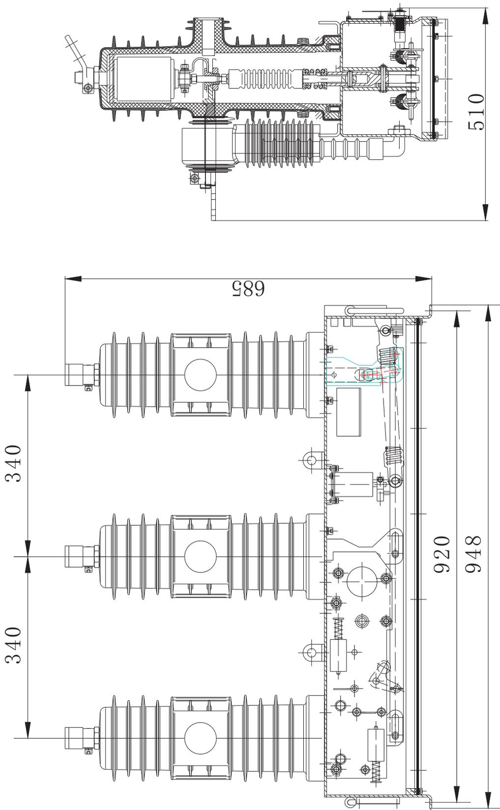
图1 ZW32R-12户外标准化柱上真空断路器外形尺寸
