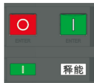
断路器合闸且无储能状态
