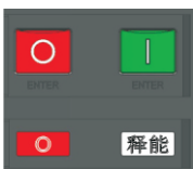
断路器断开且无储能状态
