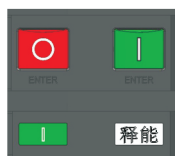
断路器合闸且无储能状态
