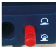
在“分离”、“试验”、“连接”三位置时，位置锁锁定，摇柄无法操作（锁定状态）
