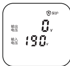
故障保护：当机器发生故障时，机器停止输出。
