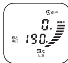
过温保护：当机器温度超过110℃时，机器停止输出。
