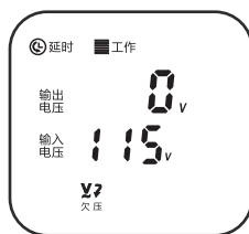
欠压：当输出电压低于184V时，机器停止输出。
