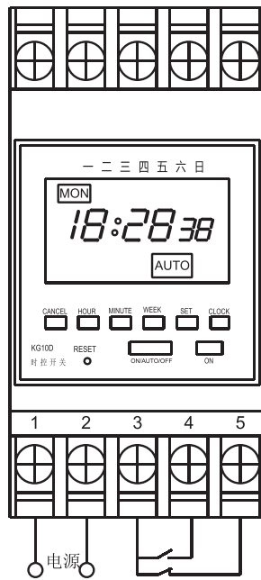
图7 KG10D-1Z接线图
