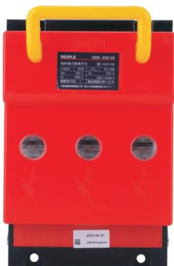
HR6熔断器式隔离开关主要用于交流50Hz(60Hz),其额定电压为400V/690V,额定电流至630A的具有高短路电流的配电路和电动机电路中,作为电源开关、隔离开关、应急开关、并作电路保护用,但一般不用来直接开关单台电动机。
