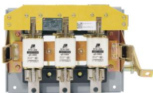
HR3系列熔断器式刀开关。适用于交流50Hz，额定电压380V、直流220V，额定电流至1000A的工业企业配电网中，作为电缆加导线及用电设备的过载和短路保护以及在网络正常供电情况下不频繁地接通和切断电源，刀开关是用来代替各种低压配电装置中刀开关和熔断器的组合电器。
